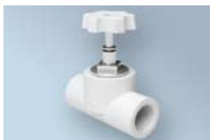
Пробочный запорный узел. Разборный узел уплотнения штока. Позволяет регулировать проходящее количество воды. Предназначен под сварку. Рабочая температура до +85 °С.
