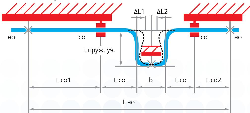
**РАСЧЕТНАЯ СХЕМА П И U-ОБРАЗНОГО КОМПЕНСАТОРА:**
