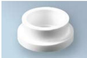
Для создания фланцевого соединения для перехода на другую трубу или задвижку. Для замыкания соединения требуется специальный стальной расточной фланец. Труба вваривается внутрь бурта.
