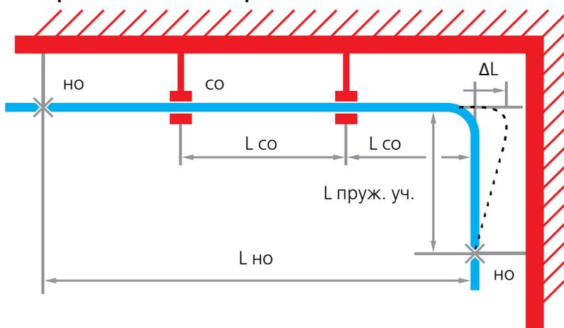
В целях устранения разночтений предлагается производить отсчет пружинящей длины от оси горизонтального участка трубопровода:
