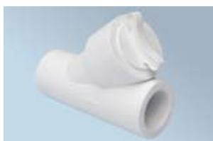
Предназначен для фильтрации, потока жидкости и газа. Фильтрующий элемент - сетка из нержавеющей стали. Фильтрация 200 мкм.
